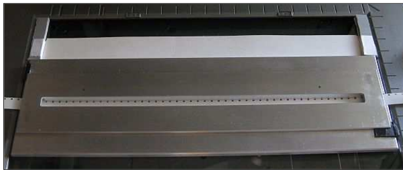
Ein Formathalter ( Ansicht von oben ) - Planhaltung des Films durch ein einliegendes Andruckprofil, das aus Aluminium herausgefräßt wurde.
