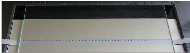
Einfacher Formathalter aus Pappe mit einer aufgelegten Glasplatte zur Planhaltung des Filmes.
