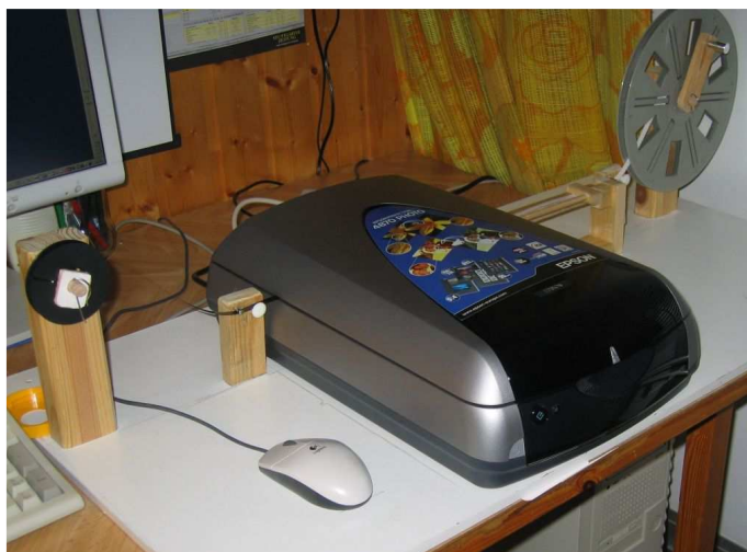
Einrichtung zum Scannen mit manuellem Filmtransport (mit Epson 4870)
