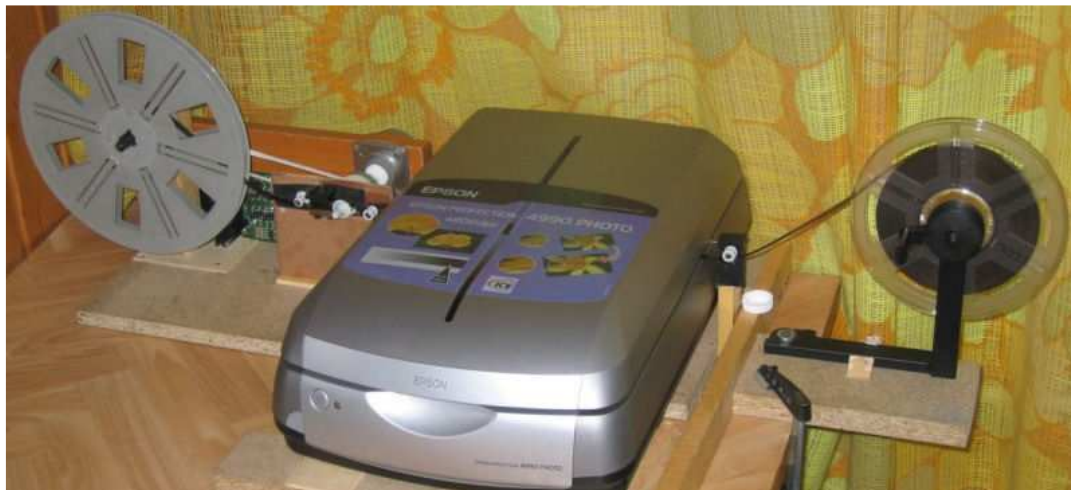
Einrichtung zum automatischen Scannen (mit Epson 4990 und Pollin Steppmotor Steuerung)
